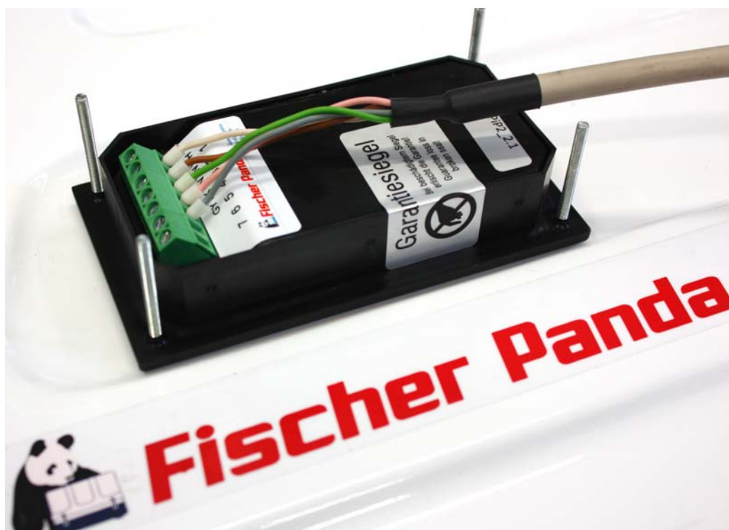
Fig. 4.2.1-1: Platine iControl2 Panda avec câble de raccordement et boîtier fermé
